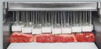
Разделенная на секции прижимная рамка не дает продукту двигаться при извлечении игл.
