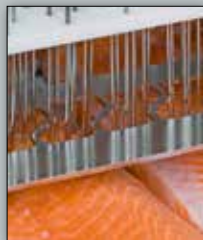
Уникальное игольчатый мостик обеспечивает равномерный и стабильный уровень инъектирования.
