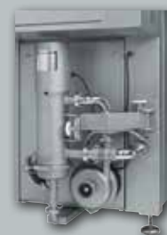
Протеиновый фильтр FM80 с автоматической очисткой и центробежный насос с высокой производительностью.
